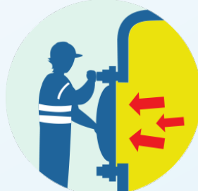
Mantenerse fuera de la "línea de fuego"
